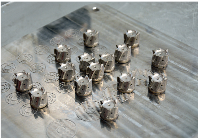
2 Additive Fertigung in der Serienanwendung: SLM-gebaute Werkzeugköpfe am Ceratizit-Standort Stuttgart (© Hanser)
